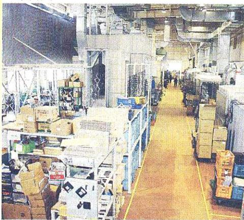
敷地は五千六百四十二平方㍍。工場棟は鉄骨造り三千百八十五平方㍍で、塗料倉庫二棟も新築した。縦一一四・六㍍、横二十七㍍の長大な工場棟の造りを生かし、入荷から被膜、塗装処理、検査出荷までのラインをほぼ一列に配置。一連の工程がスムーズに進むよう配慮した。
