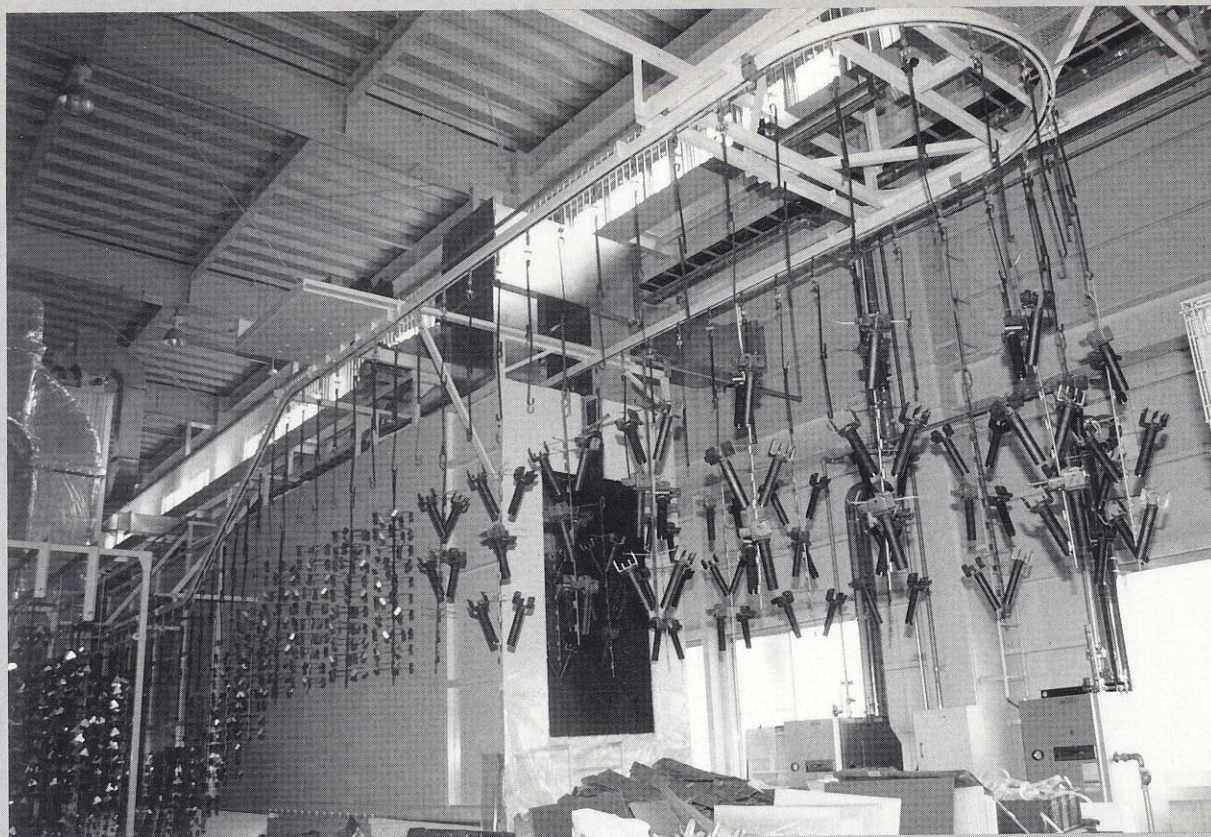
シャワー式前処理ラインの概要 分離独立している
