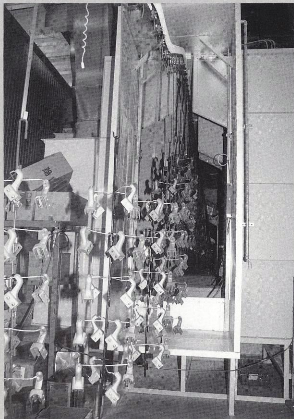
除電ブース レシプロ式除電装置を採用
