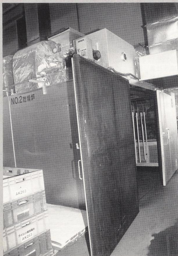
手吹き用被塗物に対応した固定炉
