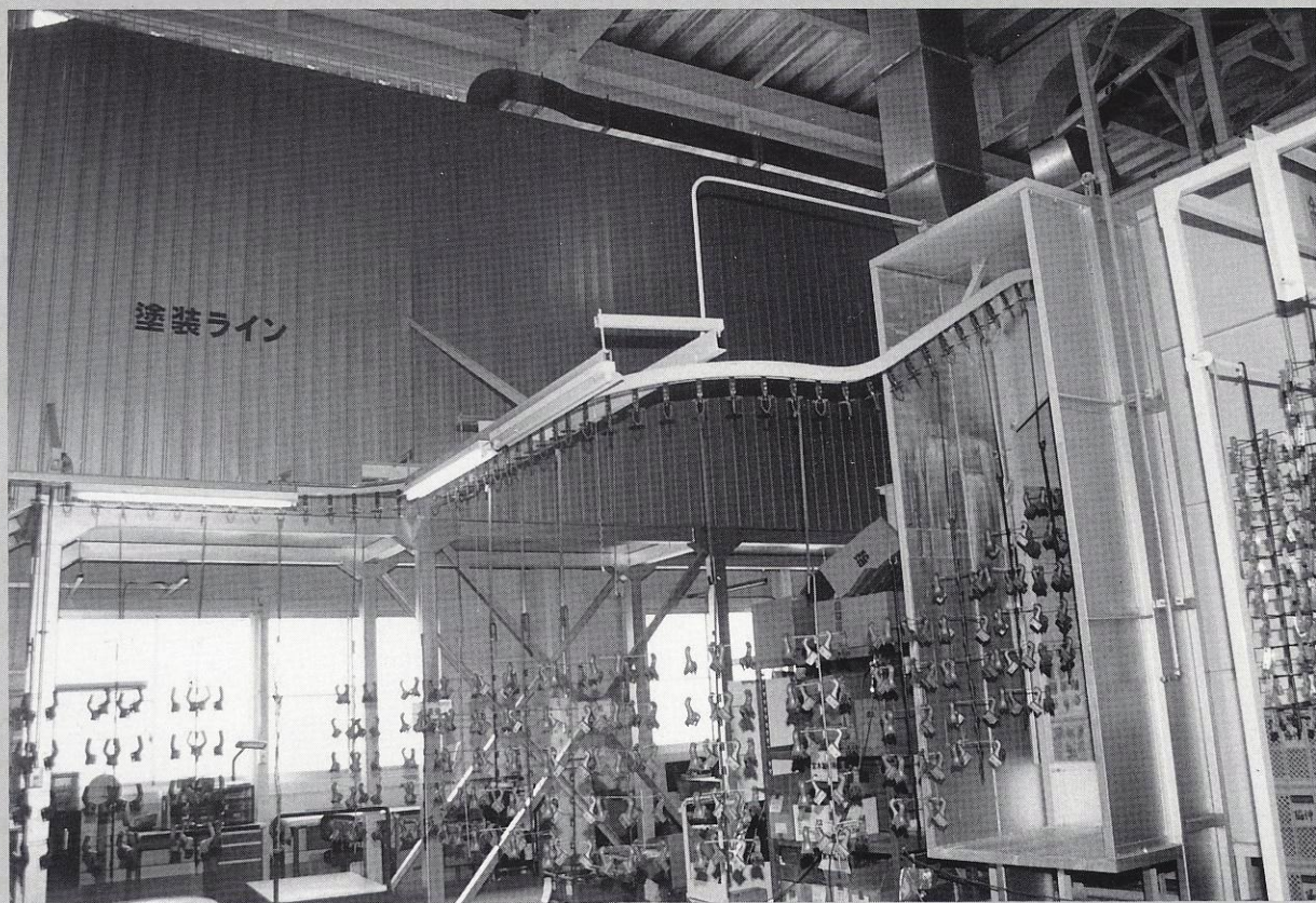
ハンガー掛けコーナーから除電ブースに流れるワーク
